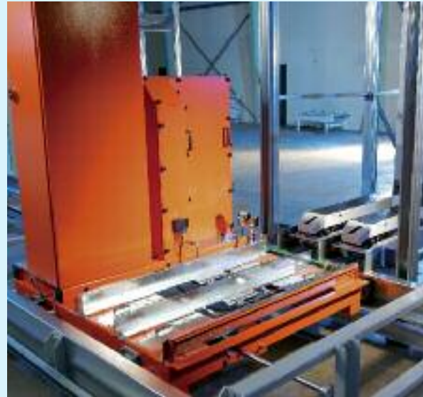
SAT-Modul mit Transferwagen zum schnellen Palettentransport in Kanallagern
