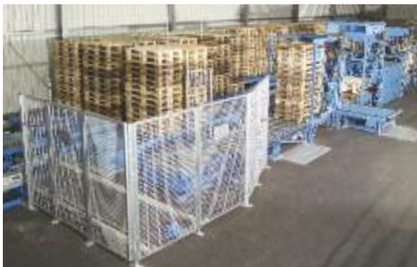
Palettenprüfanlage mit automatischem Lager für geprüfte Paletten
