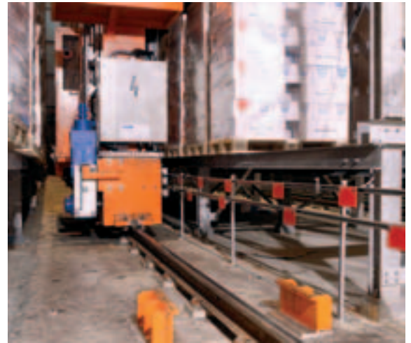
Abb. 1: Alte Drehgeber/Winkelcodierer arbeiteten nie schlupffrei und benötigten Positionierkennungen je Fach.
