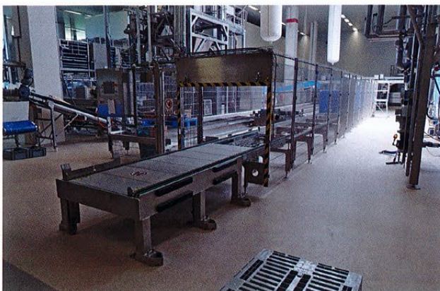
Die Anlage sichert die kontinuierliche Ver- und Entsorgung der vollautomatischen Füllstation am Teigknetter.
