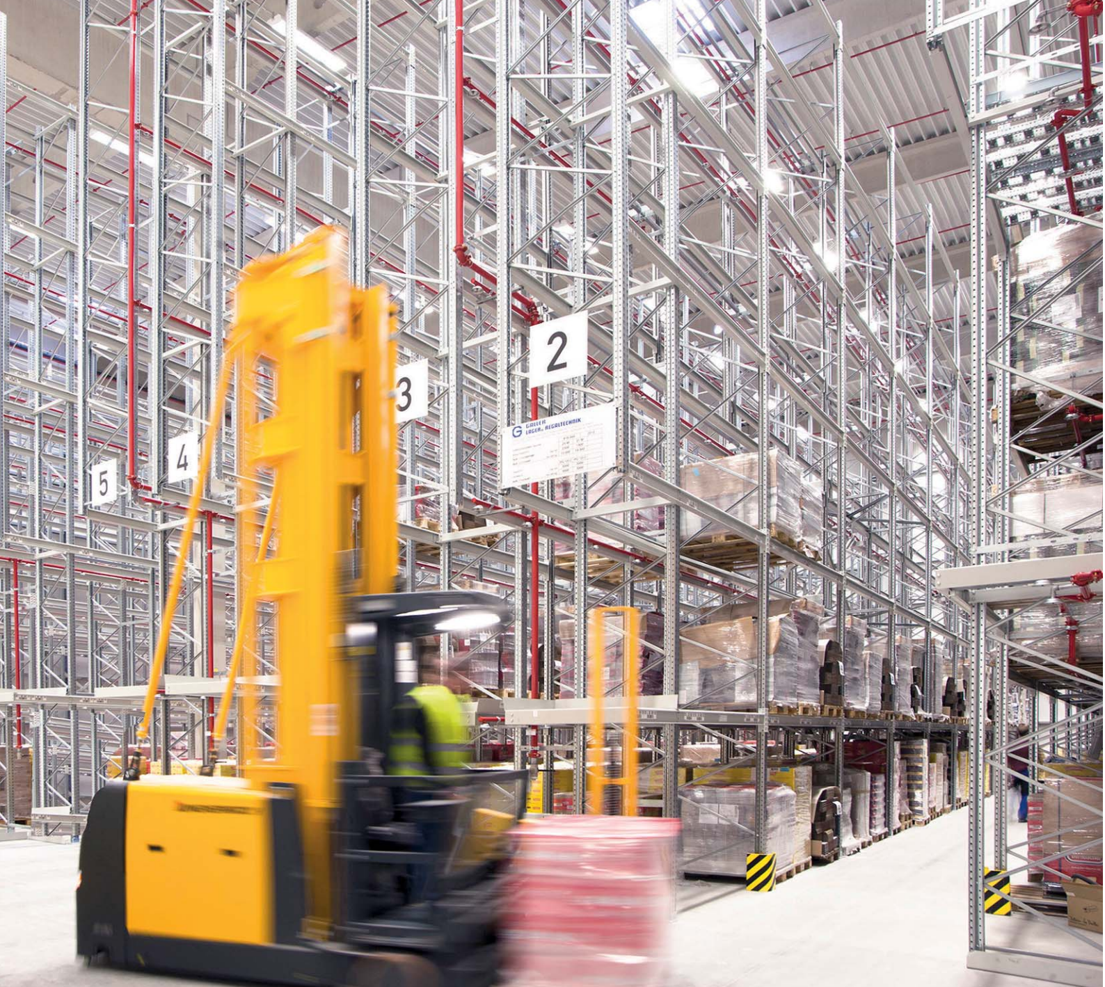
5 Im RHB-Lager werden die Paletten durch Hochregalstapler ein- und ausgelagert
