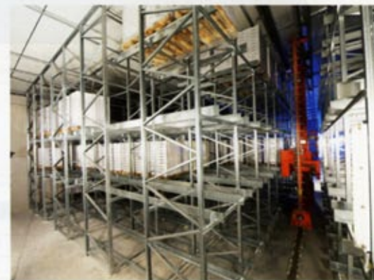
Kanallager mit Regalbediengerät
