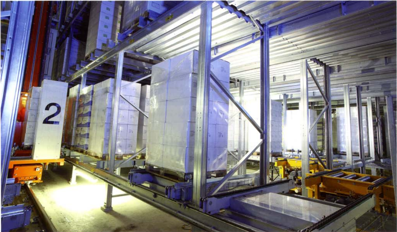
In einer Reihe: Besonders bei Produkten mit geringer Artikelvielfalt bieten Kanallager eine effiziente Alternative zum klassischen Teleskoplager.
